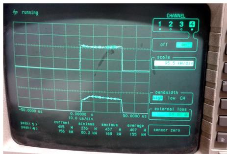
图 10 发射机输出包络
