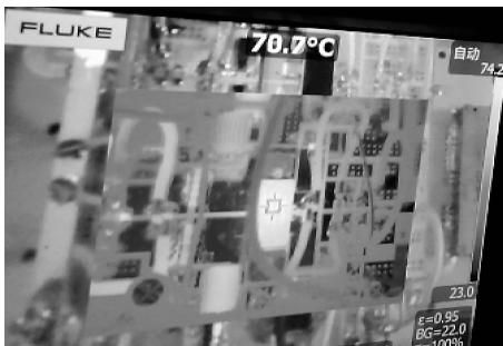
图 6 实际测试功率管的管壳温度
