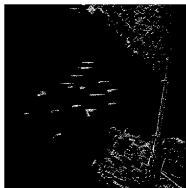
(b) 一维Otsu算法分割二值图
