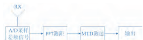
图 5 FMCW 信号处理流程图
