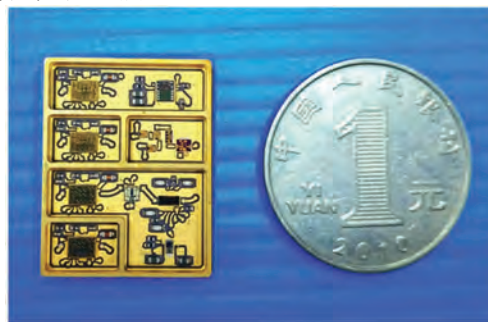
图 7 双频段四通道变频 SiP 实物图
