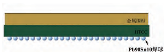
图 5 双频段四通道变频 SiP 结构的剖面示意图
