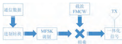
图 3 发射信号调制流程图
