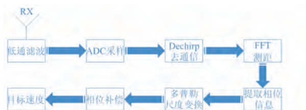
图 6 一体化信号回波处理流程图
